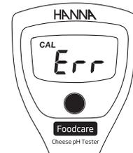
In modalità calibrazione, se la sonda si trova nella soluzione tampone corretta e si visualizza il messaggio "Err", la sonda richiede un trattamento in soluzione di pulizia. Immergere la sonda nella soluzione di pulizia per 30 minuti. Sciacquare con acqua e condizionare l'elettrodo nella soluzione di conservazione per almeno 2 ore prima di eseguire la calibrazione e la successiva misura.
