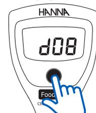
Dalla modalità di misurazione, tenere premuto il pulsante ON/OFF. Il display mostra in sequenza "OFF", "CAL" "d08" (impostazione predefinita, 8 minuti). Rilasciare il pulsante mentre si visualizza "d08". Una singola pressione sul pulsante ON/OFF cambierà il timer di spegnimento automatico in "d60" (60 minuti). Per disabilitare la funzione di spegnimento automatico, premere nuovamente il pulsante ON/OFF, il display mostrerà "d--". Tenere premuto per uscire.
