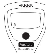
Quando il livello della batteria è basso, il tag sul display lampeggerà. Quando la batteria è scarica, si visualizza il messaggio "Erb" e il tester si spegne.
