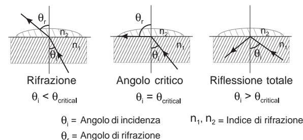
In **HI 96801** la luce proveniente dal LED passa attraverso un prisma a contatto con il campione. Un sensore di immagine determina l'angolo critico oltre il quale la luce non viene più rifratta attraverso il campione. Lo strumento compensa automaticamente la misura in temperatura e converte l'indice di rifrazione in concentrazione di zuccheri, espressa come % (in peso) Brix.
