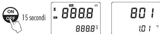
2. Continuando a tener premuto il tasto ON/OFF, premere il tasto ZERO. L'unità di misura della temperatura cambierà da °C a °F o viceversa.
