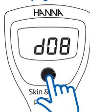
Dalla modalità di misurazione, tenere premuto il pulsante ON/OFF. Il display LCD mostrerà in sequenza "OFF", "CAL" "d08" (impostazione predefinita, 8 minuti). Rilasciare il pulsante mentre viene visualizzato "d08". Una singola pressione sul pulsante ON/OFF cambierà il timer di spegnimento automatico in "d60" (60 minuti). Per disabilitare la funzione di spegnimento automatico, premere nuovamente il pulsante ON/OFF, il display LCD mostrerà "d-". Tenere premuto per uscire.
