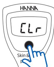
Per cancellare la calibrazione e ripristinare il tester alle impostazioni di fabbrica. Dalla modalità di calibrazione, tenere premuto il pulsante ON / OFF, il display LCD mostrerà "CLr".
