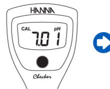
Quando "7.01" lampeggia sul display, posizionare la punta della sonda nella soluzione tampone a pH 4.01, pH 7.01 o pH 10.01.
