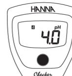
Se è stata utilizzata la soluzione standard a pH 4.01 o pH 10.01 come primo punto, il tampone viene riconosciuto e visualizzato con l'indicatore di stabilità lampeggiante.
