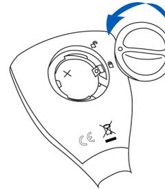
Per sostituire la batteria a litio CR2032, ruotare il coperchio della batteria situato sul retro dello strumento in senso antiorario per aprirlo. Rimuovere il coperchio e sostituire la batteria scarica inserendo la nuova con il lato "+" rivolto verso l'alto.
