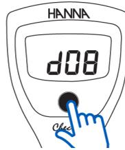
Dalla modalità di misura, tenere premuto il pulsante ON/OFF. Il pHmetro visualizzerà in sequenza "OFF", "CAL" e poi il valore impostato per lo spegnimento automatico. L'impostazione di default è di 8 minuti ("d08"). Premere il pulsante ON/OFF per cambiare. "d60" significa che lo strumento si spegnerà dopo 60 minuti, e "d--" disabilita la funzione di spegnimento automatico. Tenere premuto il pulsante per uscire dal menu
