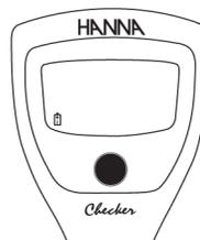
Checker® è dotato di un indicatore di batteria scarica. Quando la batteria sta per esaurirsi, l'icona lampeggia sul display. Quando la batteria è scarica, apparirà sul display "Err" e lo strumento si spegnerà.
