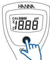
Per accendere lo strumento premere il pulsante ON/OFF. Saranno visualizzati tutte le funzioni sul display. Lo strumento entrerà in modalità di misura: sono visualizzati la lettura coerente e i tamponi calibrati.
