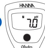
Lo strumento passerà alla modalità di misura e sarà visualizzata l'icona di calibrazione.
