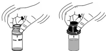
(b) Il metodo di miscelazione della cuvetta con movimenti su e giù è indicato come "shake gently" ovvero agitare delicatamente e fa riferimento a una delle icone di seguito:
