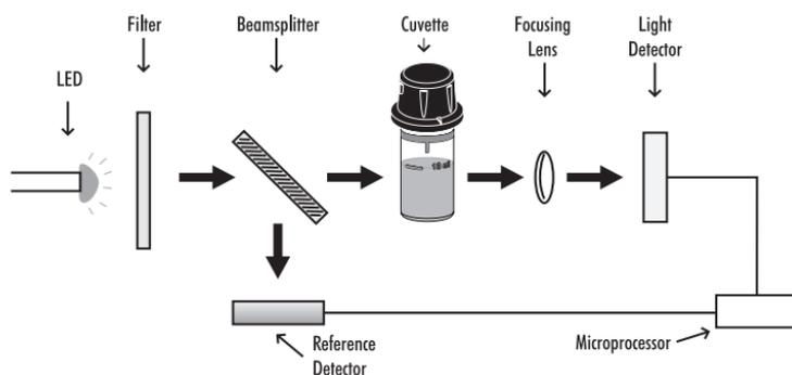
Schema del sistema ottico del fotometro
