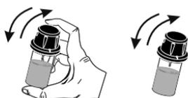
Per evitare perdite di reagente e ottenere misure più precise, chiudere la cuvetta con il sottotappo in plastica HDPE
