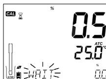
Immergere la sonda nel beaker contenente la soluzione Zero ossigeno HI 7040 e mescolare delicatamente per 2-3 minuti.
