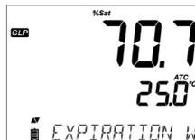
Se attivata, sarà visualizzato il numero di giorni che mancano alla scadenza della calibrazione e al messaggio di allarme "CAL DUE" (Es. "CAL EXPIRES IN 2 DAYS").
