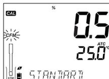
Lo strumento visualizzerà il messaggio "SAVING", memorizzerà automaticamente la calibrazione e tornerà alla modalità di misura. Prima di effettuare misure, sciacquare la sonda in acqua distillata.
