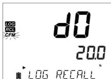
Premere il tasto **RCL**. Il display visualizza il parametro *DO* lampeggiante. Usare il tasto **►** per selezionare i dati del parametro di misura che si vogliono eliminare.
