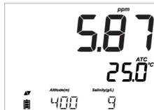
Premere **RANGE** per cambiare l'unità di misura da % a ppm (mg/l) e viceversa.
