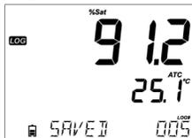
Selezionare *Manual* nel menù **SETUP**. Per avviare una registrazione manuale, premere il tasto **LOG** mentre lo strumento è in modalità di misura. Lo strumento visualizza brevemente "PLEASE WAIT", seguito dal messaggio "SAVED", che indica che la misurazione è stata registrata, con indicazione della posizione del dato.
