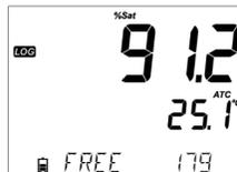
Tutti i dati memorizzati su edge<sup>DO</sup> possono essere consultati sullo strumento premendo il tasto RCL.
