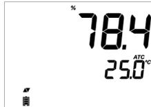
Il valore di ossigeno disciolto (in %) è visualizzato sul primo livello del display e la temperatura sul secondo livello.
