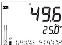
Se la temperatura è fuori scala (0.0 - 50.0 °C) durante la calibrazione, sarà visualizzato il messaggio "WRONG STANDARD TEMPERATURE" e il valore della temperatura lampeggia.
