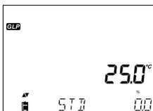
I dati dell'ultima calibrazione sono salvati automaticamente dopo una calibrazione avvenuta con successo. Per visualizzare i dati dell'ultima calibrazione, premere GLP quando lo strumento è in modalità di misura.
