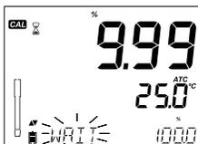
Si visualizzerà il simbolo "⌘" insieme al messaggio "WAIT" lampeggiante sul display, fino a quando la lettura non si stabilizza.
