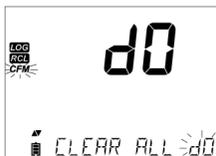
Premere **CLR** mentre il display visualizza il simbolo del parametro lampeggiante e il messaggio "LOG RECALL". Apparirà quindi il messaggio "CLEAR ALL", insieme al simbolo del parametro e a *CFM* lampeggiante. Premere **CFM**.
