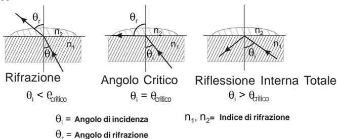
Nel rifrattometro **HI96803**, la luce proveniente dal LED passa attraverso un prisma a contatto con il campione. Un sensore di immagine determina l'angolo critico oltre il quale la luce non viene più rifratta attraverso il campione. Lo strumento HI96803 compensa automaticamente la misura in temperatura e converte l'indice di rifrazione del campione di Glucosio in unità di % in peso.
