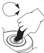
2. Usando una pipetta in plastica far gocciolare il campione sulla superficie del prisma. Riempire completamente la cella di misura.
