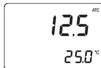
**Nota:** L'indicazione "ATC" lampeggia sul display e la compensazione automatica della temperatura è disabilitata se la temperatura è al di fuori dell'intervallo 10-40°C o 50-104 °F.
