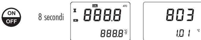
2. Continuando a tenere premuto il tasto **ON/OFF**, premere il tasto **ZERO**. L'unità di misura della temperatura cambia da °C a °F e viceversa.
