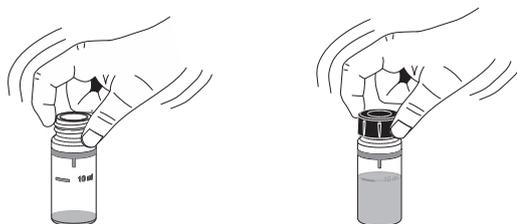
Per evitare perdite di reagente e ottenere misure più precise, chiudere la cuvetta prima con il tappino (sottotappo) in plastica HDPE e poi con il tappo nero.
