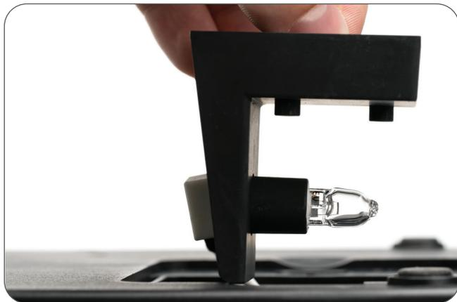
Iris è dotato di una lampada alogena al tungsteno, che consente di misurare un'ampia varietà di lunghezze d'onda.
