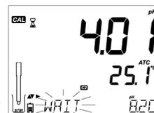
Se si desidera modificare il valore del tampone personalizzato, premere **►**. Il valore del tampone inizierà a lampeggiare. Utilizzare i tasti **FRECCIA** per cambiare il valore del tampone.
