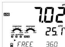
Premendo nuovamente il tasto **LOG** si fermerà la sessione di registrazione. Sarà visualizzato il messaggio “LOG STOPPED” per pochi secondi. Se si verifica un errore del sensore durante la registrazione, il messaggio “OUT OF SPEC.” comparirà alternato alle informazioni di registrazione.
