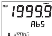
Se la lettura è fuori scala, si visualizza "WRONG" sul terzo livello del display.
