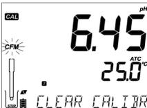
Per eliminare i dati premere invece il tasto **CFM**. Si visualizza il messaggio "CLEAR ALL" seguito dal messaggio "CAL DUE".
