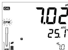
Il valore di calibrazione è visualizzato sul display principale, mentre il terzo livello del display visualizzerà il secondo valore del tampone atteso.
