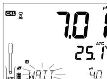
Procedere con il secondo punto di calibrazione, immergere la sonda nella seconda soluzione.
