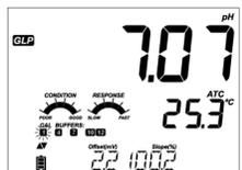
Se un tampone non è presente nell'ultima calibrazione, sarà visualizzato il valore del tampone lampeggiante.
