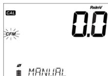
Premere **CFM** per confermare la calibrazione. Lo strumento visualizzerà "0.0" RelmV sul primo livello del display con "CFM" lampeggiante e il messaggio "MANUAL" sul terzo livello. In questo momento l'offset di mV relativi è uguale alla lettura di mV assoluti.
