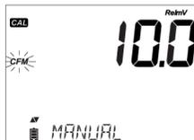
Se l'offset calcolato è maggiore di  $\pm 2000$  mV, comparirà il messaggio "MAX LIMIT REACHED" sul terzo livello del display. Il valore non può essere confermato fino a quando non si elimina l'errore.
