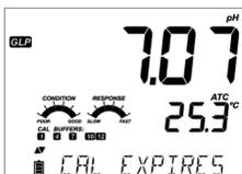
Se abilitata, si visualizzerà il numero di giorni che mancano alla scadenza della calibrazione: ad esempio "CAL EXPIRES IN 2 DAYS".
