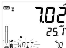
Quando la lettura è stabile e all'interno del valore del tampone selezionato, il simbolo "CFM" lampeggia. Premere **CFM** per confermare la calibrazione.
