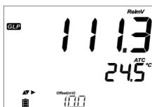
L'offset di calibrazione di mV relativi è visualizzato sul terzo livello del display.
