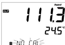
Se la calibrazione non è stata eseguita, lo strumento visualizza il messaggio "NO CAL" lampeggiante.
