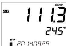
Premendo i tasti **▼▲**, si visualizza la data dell'ultima calibrazione insieme alla lettura corrente.
