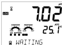
Lo strumento visualizza brevemente "PLEASE WAIT", poi comparirà il simbolo di stabilità (clessidra), "LOG" e il messaggio "WAITING". La registrazione può essere interrotta durante la visualizzazione del messaggio "WAITING", premendo nuovamente **LOG**.
