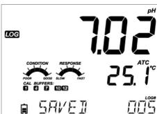
Quando la lettura è stabile secondo il criterio di stabilità selezionato, sarà visualizzato il messaggio "SAVED", che indica che la misurazione è stata registrata, con indicazione della posizione del dato.
