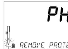
Sciacquare l'elettrodo pH con acqua distillata. Immergere la punta dell'elettrodo per circa 3 cm nel campione da analizzare, assicurandosi che la giunzione/setto poroso siano completamente immersi, e mescolare delicatamente. Attendere che l'elettrodo si stabilizzi.
