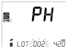
Il display ritorna automaticamente al parametro pH. Premere il tasto **RCL** due volte per tornare in modalità di misura.
