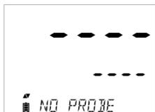
Se la sonda non è collegata correttamente o non è stata riconosciuta, si visualizza il messaggio "NO PROBE".
