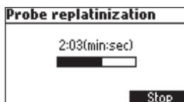
Il processo può essere interrotto premendo il tasto **Stop** oppure **ESC**.
