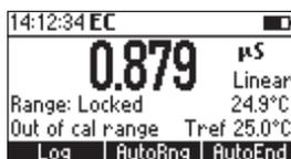
La funzione "autoranging" può essere disattivata anche selezionando un **fixed range** (valore fisso) nel menù SETUP. In questa modalità lo strumento visualizzerà le letture con la risoluzione fissa. È possibile visualizzare un massimo di 6 cifre. Quando la lettura supera il valore massimo della **fixed range** (valore fisso), il valore lampeggerà. Per disabilitare la modalità **fixed range** entrare in SETUP e selezionare la modalità autoranging.
