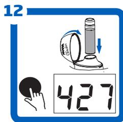
Inserire la cuvetta nel Checker e chiudere il coperchio. Premere il pulsante. Lo strumento visualizzerà il valore di Calcio in ppm.
