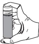
Rimettere il tappo alla cuvetta e agitare energicamente per **15 secondi**, fino a completo scioglimento del reagente in polvere.
