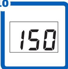
10 Allo scadere del timer, il Checker mostrerà a display la concentrazione di **Fosforo in ppb**. Moltiplicando per il valore per 3.066 si otterrà la concentrazione in Fosfati
