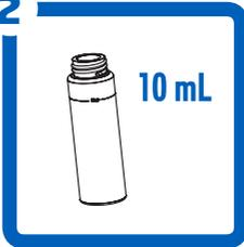
2 Riempire la cuvetta con **10 mL di campione non reagito**. Vedere sul retro l'avvertenza "A" per il corretto riempimento della cuvetta.
