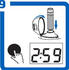
9 Inserire la cuvetta nel Checker e chiudere il coperchio. Tenere premuto il pulsante ON/OFF per avviare il timer di **3 minuti**.
