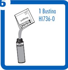
6 Aggiungere il contenuto di una bustina di reagente **HI736-0 Phosphorus Ultra Low Range reagent**. Vedere sul retro l'avvertenza "C" per la corretta gestione del reagente in polvere.
