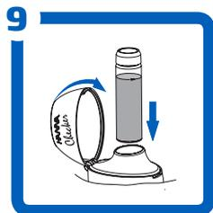
Rimettere il tappo alla cuvetta. Inserire la cuvetta nel Checker e chiudere il coperchio.
