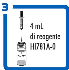
Utilizzando la siringa da 5 mL, aggiungere esattamente 4 mL di reagente HI781A-0 nella fiala di miscelazione grande.
