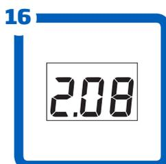
Quando il timer finisce, il Checker effettuerà la lettura. lo strumento visualizzerà la concentrazione di Nitrati in ppm. Il Checker si spegnerà 10 min dopo la lettura.
