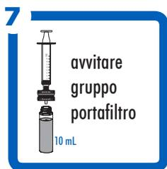
Svitare l'ago smussato dalla siringa da 10 mL e avvitare il gruppo portafiltra precedentemente configurato. Posizionare la siringa con il gruppo portafiltra sopra una cuvetta stretta da 10 mL.
