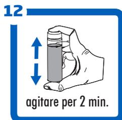
Rimettere il tappo alla cuvetta e agitare energicamente per 2 minuti.
