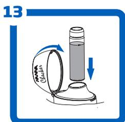
Inserire la cuvetta nel Checker e chiudere il coperchio.
