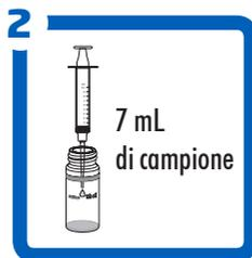
Utilizzando la siringa da 10 mL, prelevare il campione da analizzare e versare esattamente 7 mL nella fiala di miscelazione grande.
