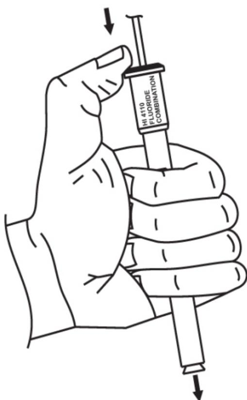
10. Chiudere il tappo del corpo dell'elettrodo e riempire il corpo dell'elettrodo fino a quando il livello della soluzione di riempimento è appena al di sotto del foro di riempimento.
