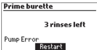
Questo messaggio di errore viene visualizzato quando la pompa non funziona correttamente. Controllare tubi, valvola e siringa. Premere **Restart** e ripetere l'operazione.
