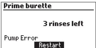
Questo messaggio di errore compare quando la pompa non funziona correttamente. Controllare i tubi, la valvola e la siringa. Premere **Restart** per riprovare.
