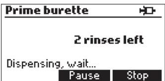
Schermata di preparazione della buretta mentre il sistema di dosaggio sta funzionando.
