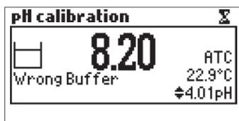
Un tampone confermato durante la calibrazione sarà rimosso dalla lista dei tamponi disponibili. Se il valore misurato dallo strumento non è vicino al valore del tampone selezionato, il messaggio di errore "Wrong Buffer" (Tampone errato) sarà visualizzato sul display. Verificare di aver utilizzato la corretta soluzione standard o che i sensori siano
