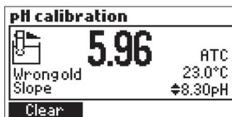
Si visualizza il messaggio “Wrong Old Slope” (Slope precedente errata) se c’è un’incongruenza tra la calibrazione corrente e quella precedente. Cancellare la calibrazione precedente premendo **Clear** e ripetere la calibrazione. Lo strumento memorizzerà i valori confermati durante l’ultima calibrazione.
