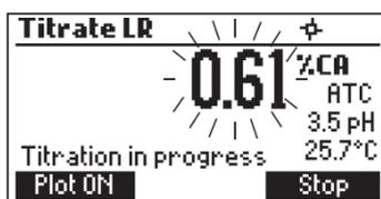
La curva di titolazione può essere visualizzata durante una titolazione, premendo **Plot ON**. Premere **Plot OFF** per uscire da questa modalità.
