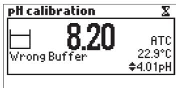
Il messaggio "Wrong Buffer" (Tampone errato) è visualizzato quando il valore di pH è fuori scala. Utilizzare soluzione tampone fresca e riprovare, altrimenti pulire l'elettrodo seguendo la procedura di pulizia. Premere **ESC** per uscire dalla modalità di calibrazione pH.
