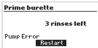
**Nota:** Questo messaggio di errore compare quando la pompa non funziona correttamente. Controllare il tubo, la valvola e la siringa. Premere **Restart** per riprovare.
