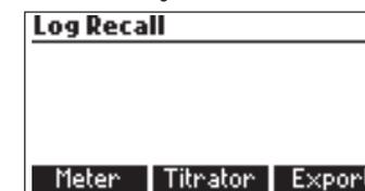
Quando è collegato un dispositivo di archiviazione USB esterno, viene visualizzata il tasto "**Export**". I dati ottenuti dal misuratore e dal titolatore vengono registrati sul dispositivo di archiviazione in due file di testo separati.
