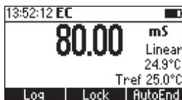
Nota: Il simbolo  $\blacklozenge$  a fianco della lettura della temperatura significa che la temperatura può essere inserita dall'utente (opzione Manuale selezionata in SETUP o temperatura fuori scala).
