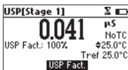
Se la modalità di temperatura è inserita manualmente, premere **USP Fatt.** per selezionare il fattore USP da modificare (utilizzare le  $\blacklozenge$  fino al 100%). Per aumentare la precisione dell'analisi diminuire il valore del fattore USP.
