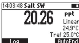
Questa è una scala pratica basata sulla misurazione precisa della conducibilità elettrica di una soluzione con scala di salinità nota.
