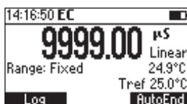
Sono disponibili due modalità di temperature selezionabili: la lettura direttamente dal sensore interno alla sonda o l'inserimento manuale.
