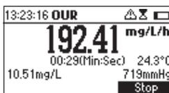
Per terminare la misurazione OUR prima dell'intervallo di tempo massimo impostato premere **Stop**.
