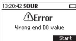
Premere **Start** per iniziare una nuova misurazione SOUR o **ESC** per tornare alla schermata di misura.
