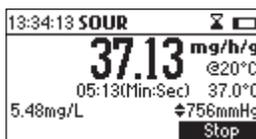
Se la lettura di D.O. è minore del valore minimo di D.O. finale impostato, si visualizzerà un'icona di avviso e si sentirà un beep ogni due secondi. Premere **Stop** per terminare la misurazione e per fermare il beep.
