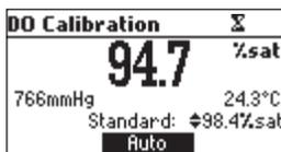
Impostare il valore di ossigeno disciolto, utilizzando i tasti freccia, per determinare il valore di D.O.
