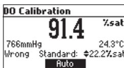
Durante la modalità di calibrazione manuale è possibile tornare alla modalità di calibrazione automatica premendo il tasto funzione **AUTO**. Lo strumento selezionerà lo standard più vicino alla lettura corrente di D.O.
