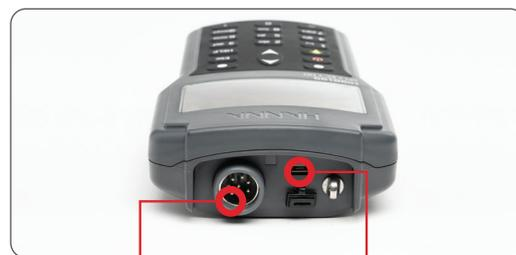
Collegamento della sonda conconnettore Quick-DIN
